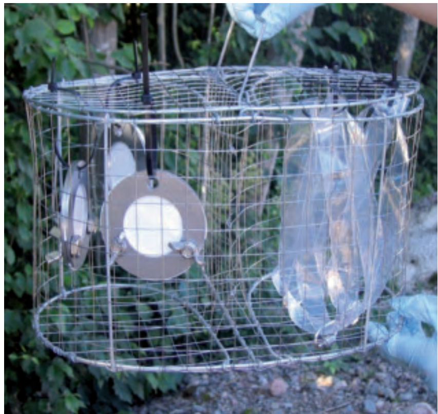
Kuva 2. Näytteenotossa käytettiin apuna passiivisia keräimiä. Kuvassa vasemmalla on vesiliukoisille yhdisteille tarkoitettu POCIS-keräin ja oikealla heikosti vesiliukoisille yhdisteille tarkoitettu SPMD-keräin.
