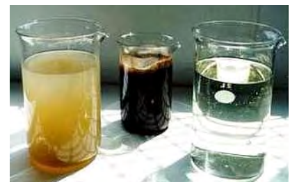
Kuva 5. MBR-prosessin tuleva jätevesi, aktiiviliete ja suodatettu jätevesi.
