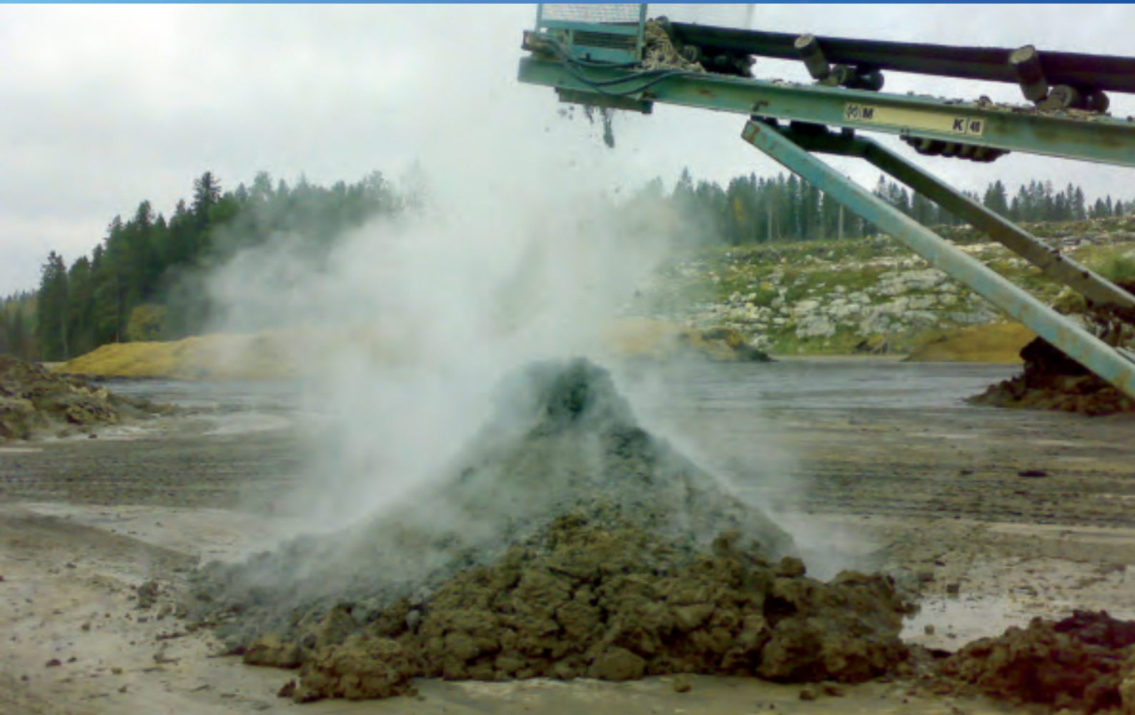
Kuva 3. Ammoniakkia ja vesihöyryä muodostui prosessissa runsaasti kaikkein suurimmilla kalkkiannostuksilla.
