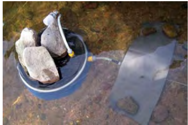
Kuva 8. Järven pohjasedimenttiin asennettu suotomittari ja siihen kytketty mittapussi, joka on peitetty suojaverkolla mittapussin paikallaan pysymisen varmistamiseksi.
