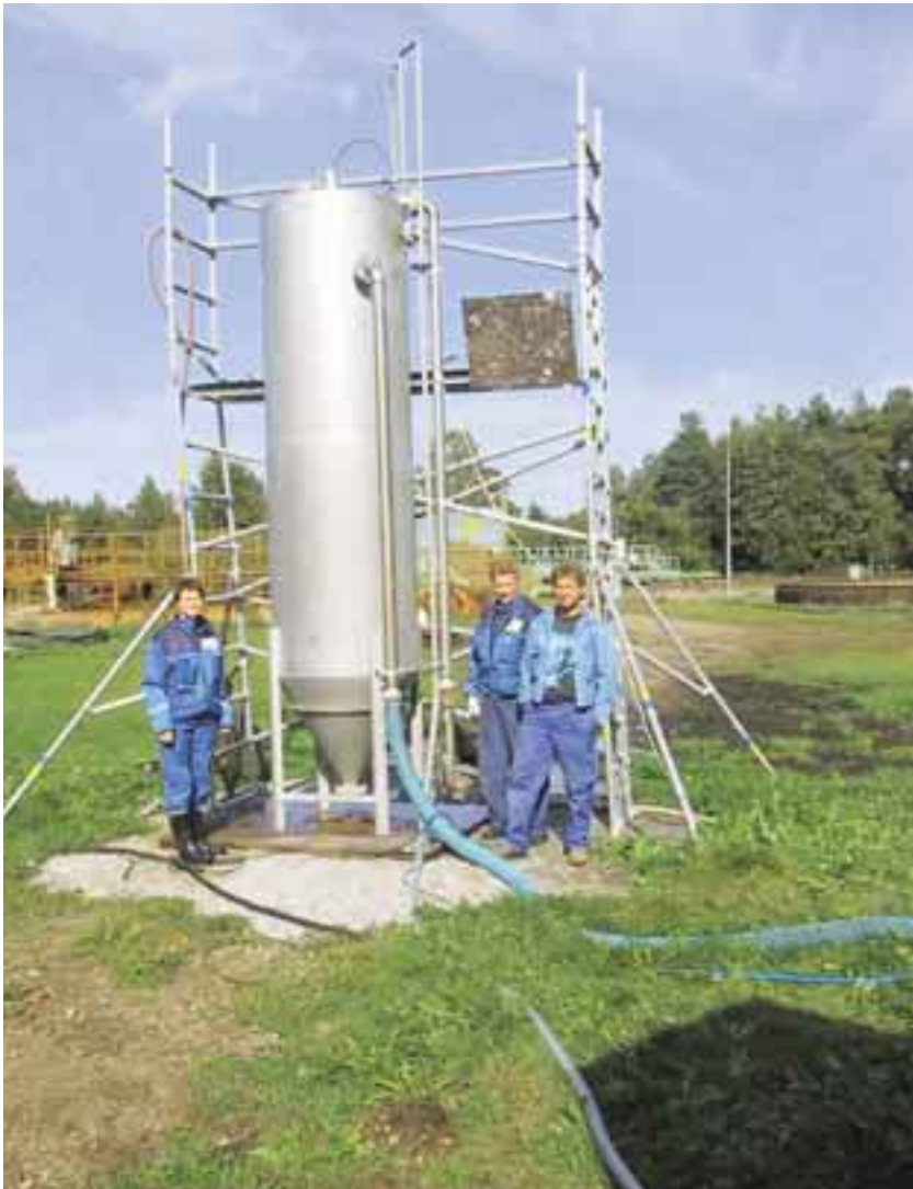
Kuva 4. Jatkuvatoiminen suodatin, koelaite Lappeenrannan puhdistamolla. (Kuva: lina Laitinen)
