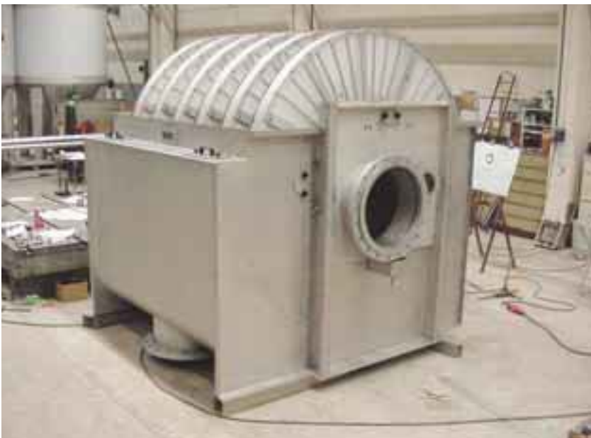
Kuva 2. Viirakankaalla varustettu kiekkosuodatin ilman suojakantta. (Kuva: Nordic Water Products Ab)
