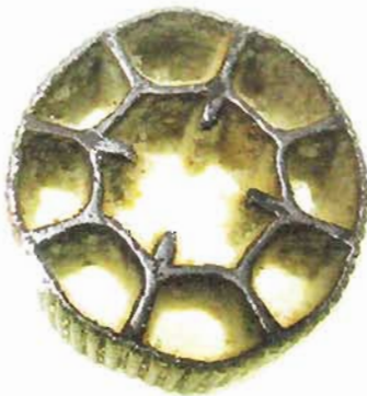
Kuva 4. Kantoaine nitrifikaatio-osasto 3 kuukauden käytön jälkeen.
