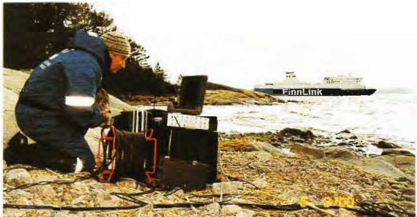
Kuva 2. Aalto- ja virtausanturin mittaustietokone sijaitsi rannalla. (Kuva VTT 2000)
