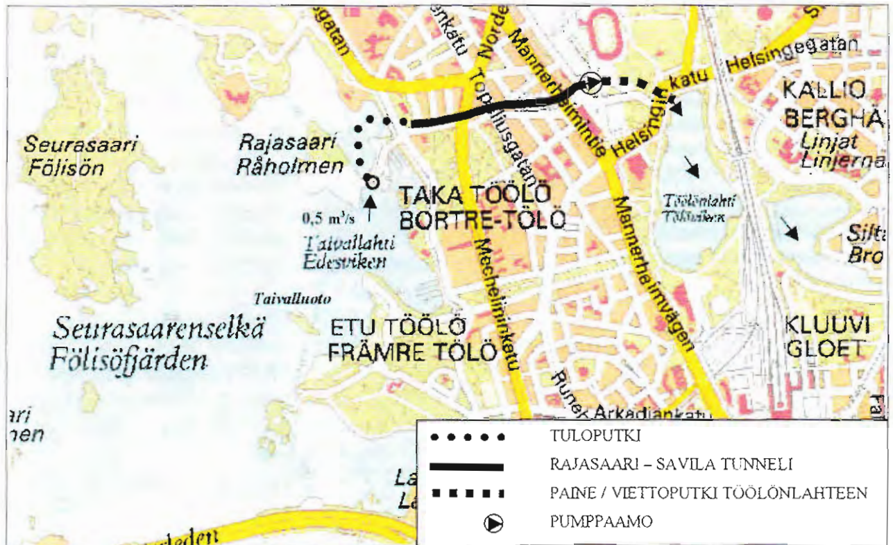
Kuva 2. Meriveden johtamisen yleiskartta (SCC Viatek Oy).
