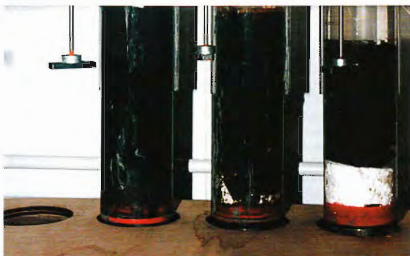
Kuva 1. Töölönlahden pohjasedimentin inkubointia läpivirtauskoelaitteistossa Helsingin ympäristökeskuksen vesilaboratoriossa (Kansanen et al. 1995).
