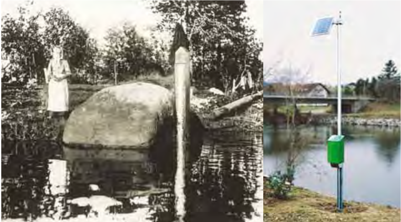
Kuva 1. Vanhaa ja uutta hydrometriaa: Koitajoen vedenkorkeusasteikko 1910-luvulla sekä aurinkokennoilla sekä GSM -modeemilla varustettu automaattinen vedenkorkeuden mittausasema. (Kuvat: SYKE ja OTT Messtechnik GmbH)
