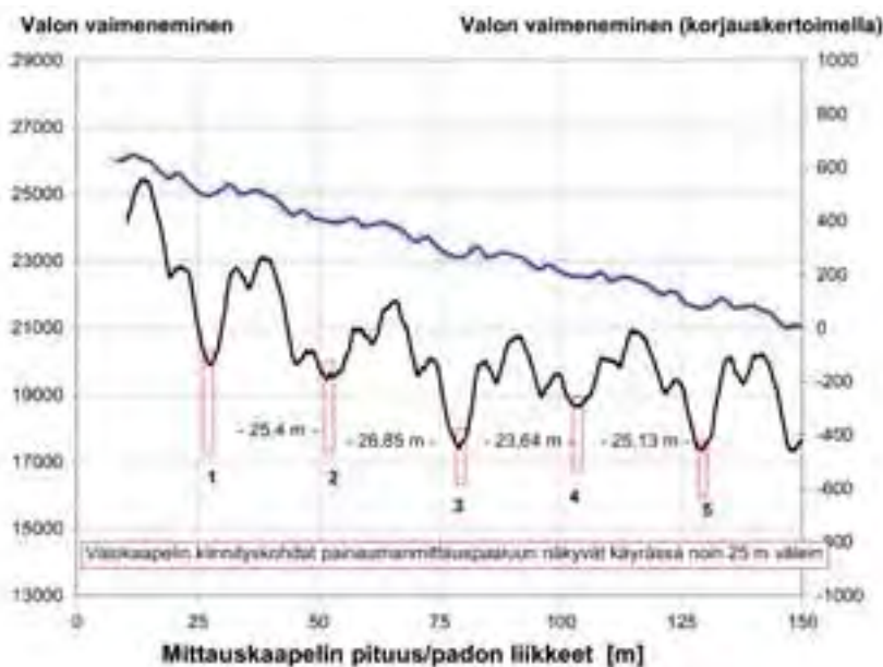
Kuva 2. Valokaapelista saadut mittaustiedot tallentuvat karttapohjaiseen rekisteriin, joka antaa vuototilanteessa hälytyksen.
