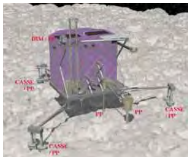
Kuva 4. Taiteilijan näkemys Rosetta-luotaimen Philae-laskeutujasta sekä PP-mittalaitteen viidestä elektrodista. Mittauselektrodit ovat etujaloissa, yksi virtaelektrodi kolmannessa jalassa. Toisena virtaelektrodina voidaan käyttää vaihtoehtoisesti kahta keskellä olevaa elektrodia, jolloin mittausgeometriaa voidaan vaihtaa. Nämä elektrodit on kiinnitetty laskeutujan muiden mittalaitteiden antureihin. (Kuva: SESAME)
