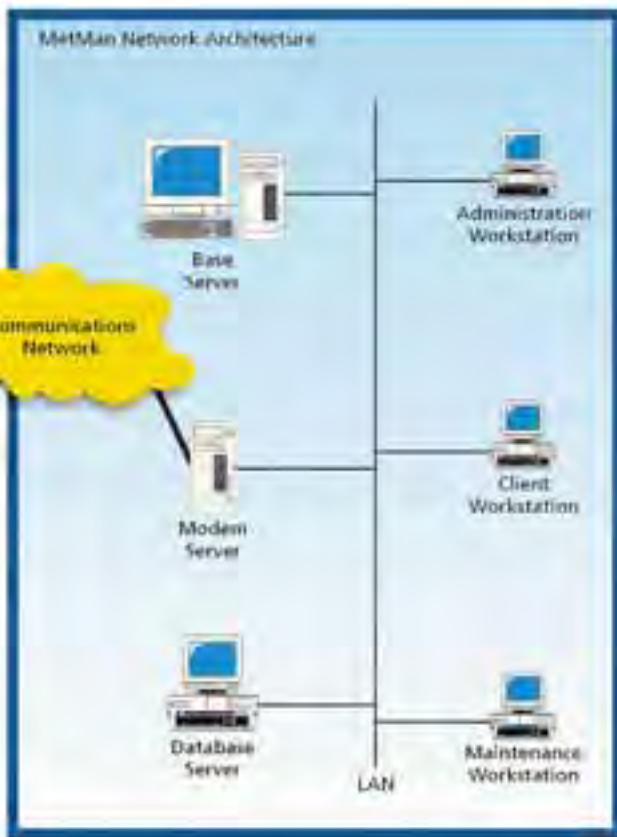
Kuva 2. Hydrometeorologisen tiedon hallintajärjestelmä, joka sisältää myös tarvittavat ohjelmistot ja tietokannat (MS Access tai Oracle) havaintoverkon ylläpitoon ja asemien konfigurointiin.
