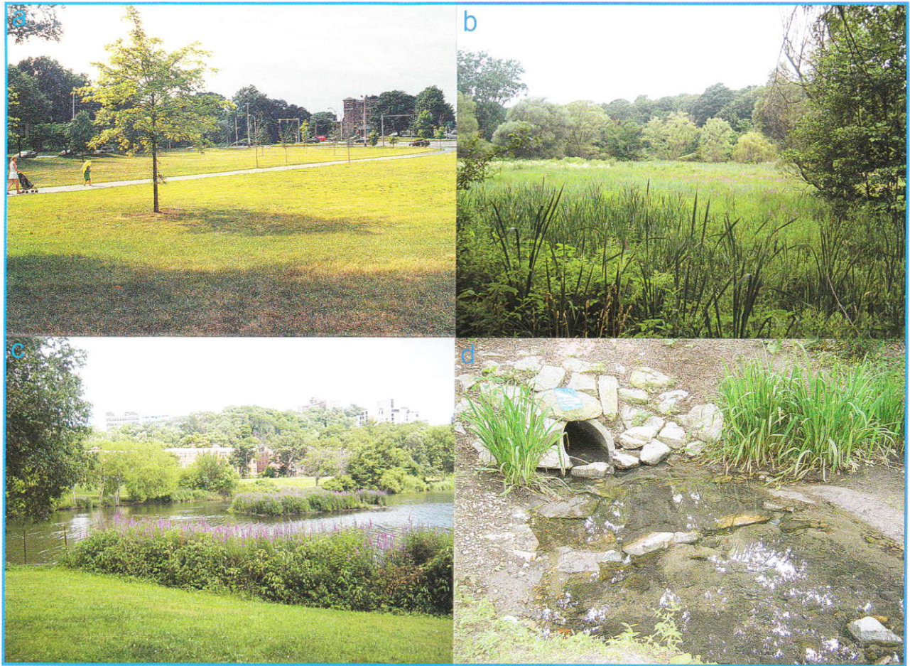
Kuva 5. a) Muddy River virtaa tienristeyksessä yksinkertaistetun viherrakenteen alla. b) Muddy River-joen luontaisena säilynyttä kosteikkoaluetta. Osana Boston Emerald Neclace-puiston luonnonmukaista tulvien hallintaa c) uomaan on palautettu virtaamia tasaavia saaria ja kosteikkokasvillisuuden peittämää rantaa. d) Putkitettuja valuntareittien osuuksia on avattu ja reiteille istutettu kosteikkokasvillisuutta sekä aseteltu kiviä. (Kuva: Outi Salminen)
