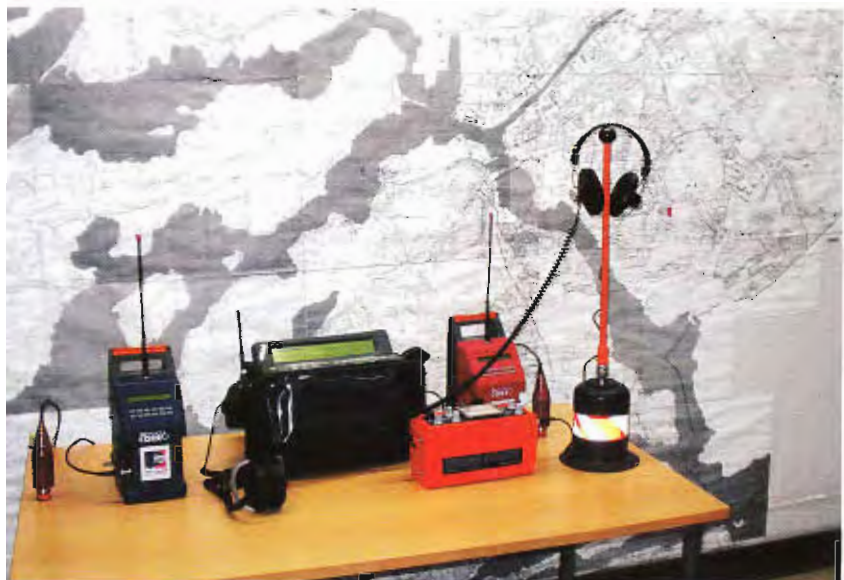
Vesijohtovuotojen paikannuksessa käytettäviä laitteita: taustalla akustokorrelaattori lähettimiseen, etuoikealla maakuuntelumikrofoni.
