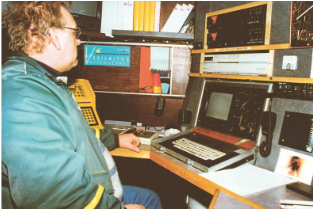
Kuva 4. Sisäkuva viemäreiden tv-kuvausautosta mallia "Vaasa" 1980-luvulla. Kuvassa Erik Blomberg.
