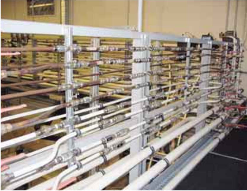
Kuva 1. Koevesijohtoverkosto koostuu kahdesta rinnakkaisesta muovi- ja kahdesta rinnakkaisesta kupariputkilinjastosta. Verkostoon asennetut biofilmikeräimet ovat osa verkostoa.
