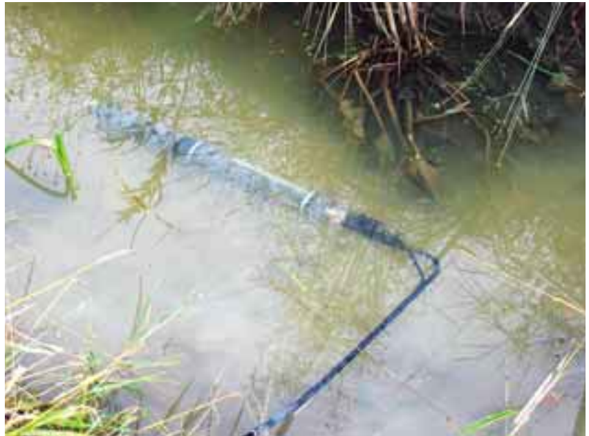
Kuva 2. Mittauslaitteena käytettiin YSI600 OMS-anturipakettia.
