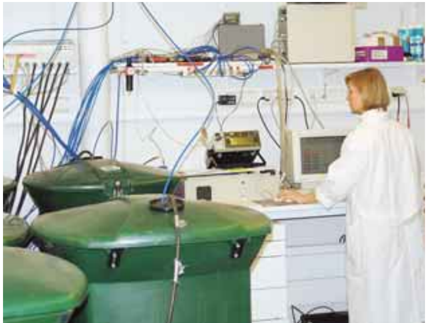
Kuva 2. VTT:n pilot-mittakaavan kompostointilaitteisto.
